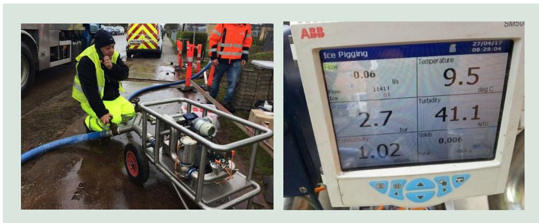
**FIGUR 5.** SUEZ Flow Analysis System (FAS-vogn) til feltmonitering.
