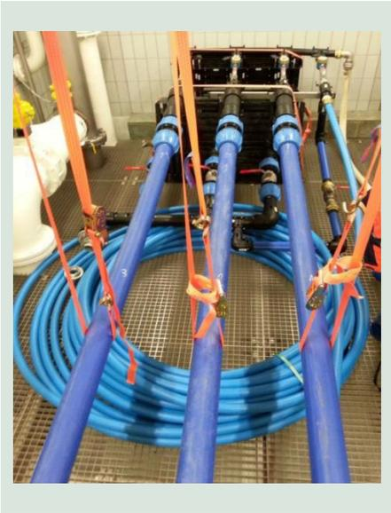
**FIGUR 7.** Opstillingen viser testriggen med de tre PEM rør, G1, G2 og G3, samt den nye PE-rulle synlig under disse.
