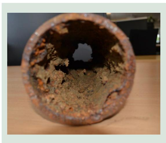
**FIGUR 14.** Støbejernsledning (Ringkøbingvej) før Ice Pigging.
