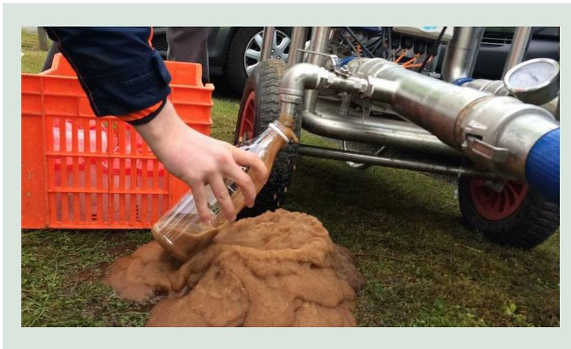
**FIGUR 6.** Udtagning af isprøve fra Flow Analysis System (FAS-vognen).
