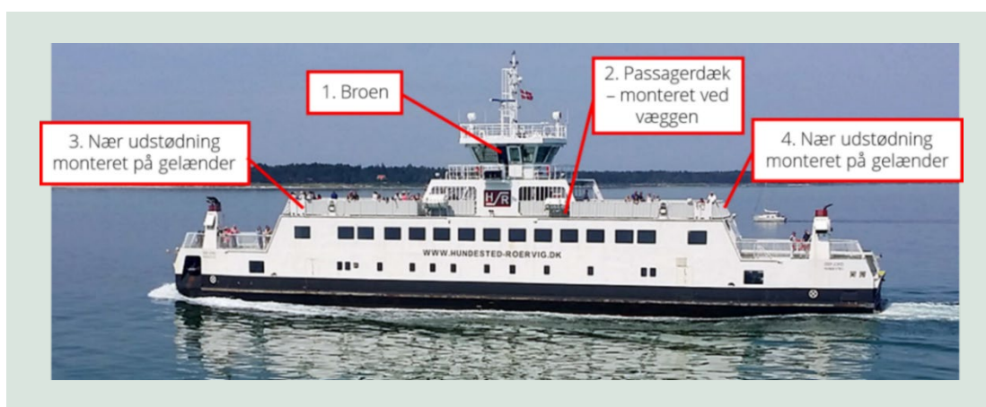
FIGUR 19. Billede af Hundested-Rørvig-færgen med angivelse af de fire målepunkter for kontinuert måling af partikkelkoncentration.
