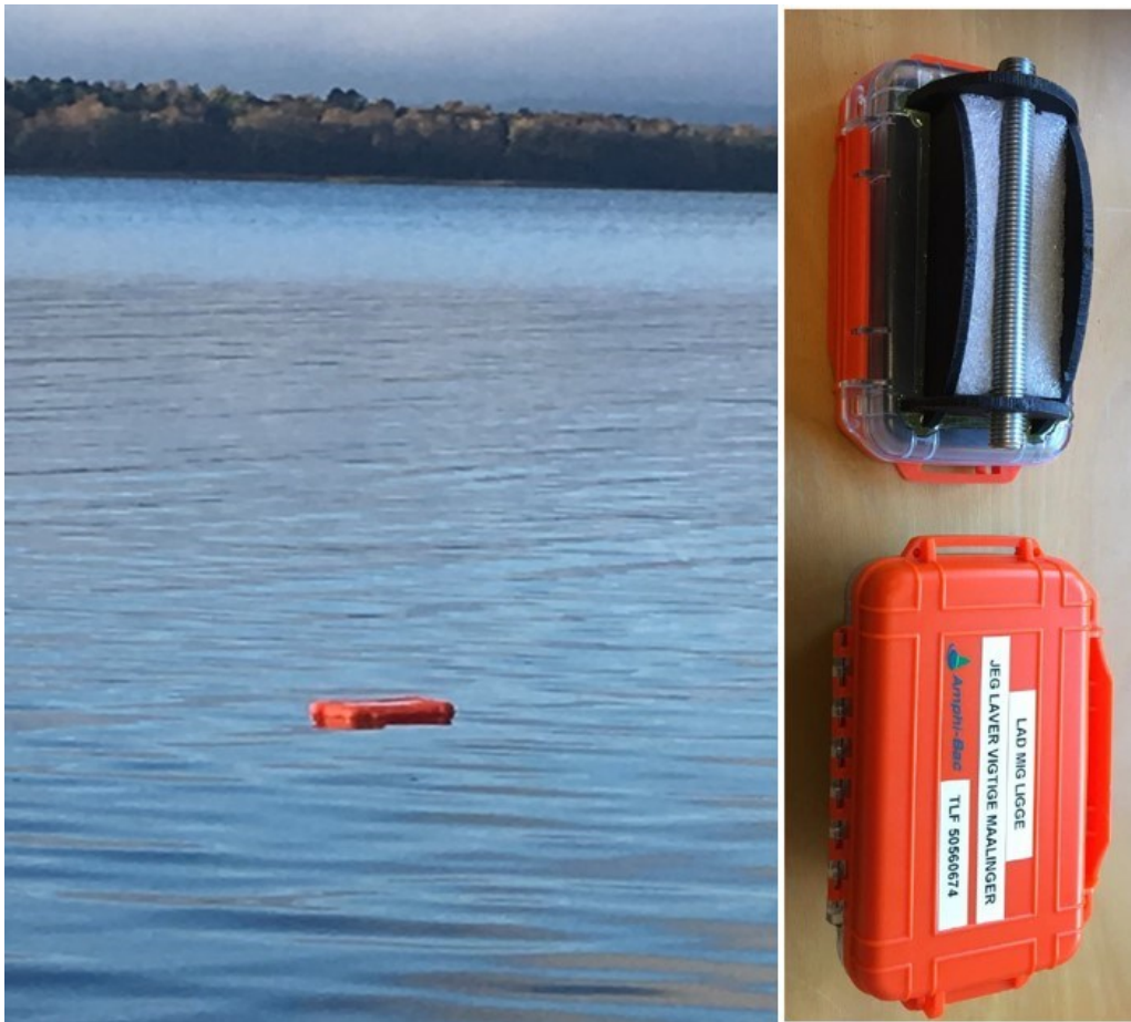
FIGUR 10. Til venstre en GPS-tracker, der flyder med strømmen i Skanderborg Sø. Til højre se for- og bagside af GPS-trackeren.
