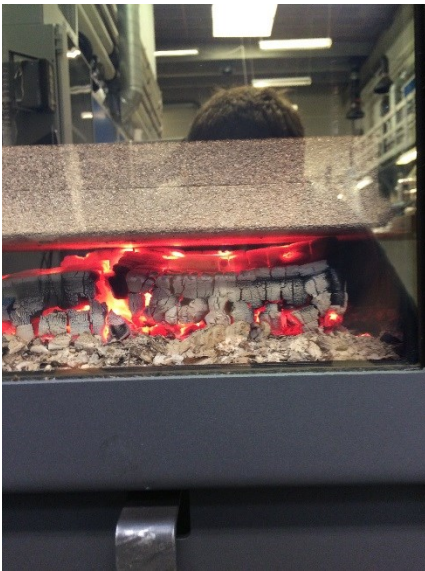
FIGUR 17 GLØDEFASEN MED SÆNKET RØGHYLDE
