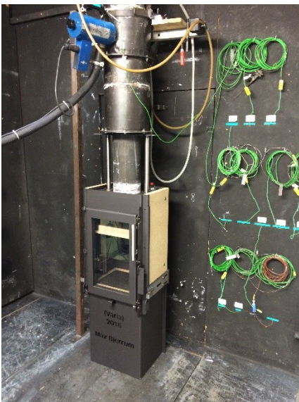
FIGUR 9 VARIA 2106-1 OPSTILLET PÅ PRØVESTANDEN
