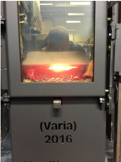
FIGUR 16 GLØDEFASEN MED SÆNKET RØGHYLDE
