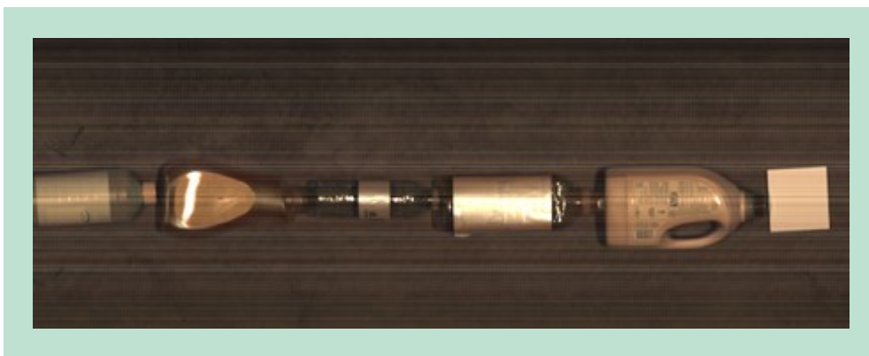
FIGUR 5. Eksempel på data, der genereres ved dataopsamlingen. Her ses et farvebillede sammensat af tre udvalgte bølglængder.
