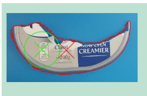
FIGUR 14. Rødt omrids indikerer omridset for det fundne emne; rødt kryds indikerer det beregnede massemidtpunkt. Grøn cirkel indikerer den største, indskrevne cirkel, der kan placeres inden for emnets omrids; grønt kryds er centrum for denne cirkel.
