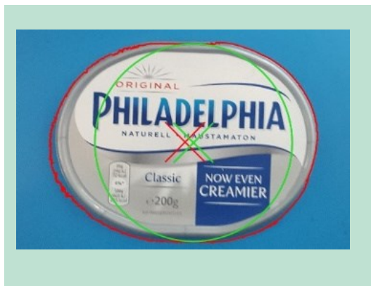
FIGUR 13. Rødt omrids indikerer omridset for det fundne emne; rødt kryds indikerer det beregnede massemidtpunkt. Grøn cirkel indikerer den største, indskrevne cirkel, der kan placeres inden for emnets omrids; grønt kryds er centrum for denne cirkel.
