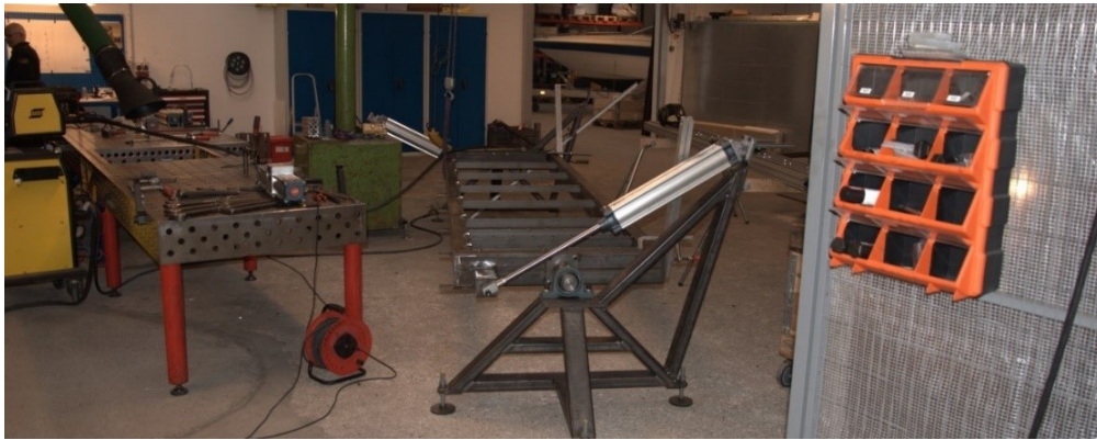
Illustration: Automatisk fikstur under udvikling
