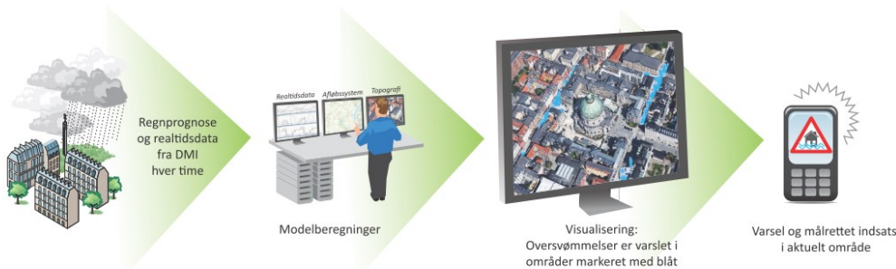
Figur 3-1. OMOVAST funktionsskema. Modellen genererer hver time et oversvømmelsesvarsel baseret på prognoser fra DMI. Realtidsdata (regnmålinger, havvandstande) bruges til at sikre, at modellen altid er opdateret i forhold til den aktuelle tilstand.
