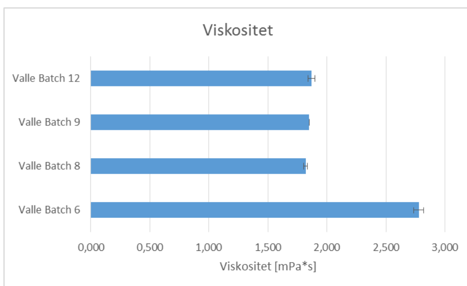
Figur 6-2 Resultatet af viskositetsmålinger på forskellige batch af oprensede vallefraktioner. Testet ved 4 % proteinkoncentration, 22 grader og 50s-1 i omdrejningshastighed.
