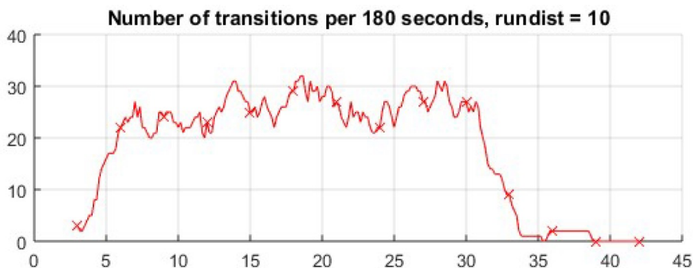
Figur 8: Måling af antal partikler i en vandstrøm for at verificere, at systemet måler en fast koncentration stabilt over tid. Y-aksen viser hvor mange partikler der er talt over de sidste 180 sekunder. X-aksen er tid i minutter. Forsøget viste, at det var muligt at måle en stabil koncentration i 30 minutter.
