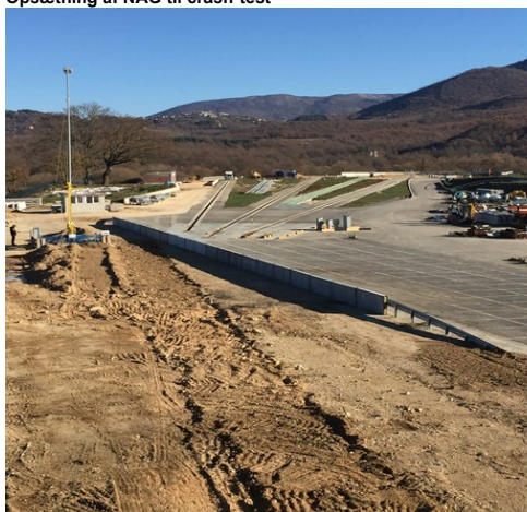
Opsætning af NAG til crash-test
