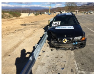
Opsætning af NAG til crash-test
