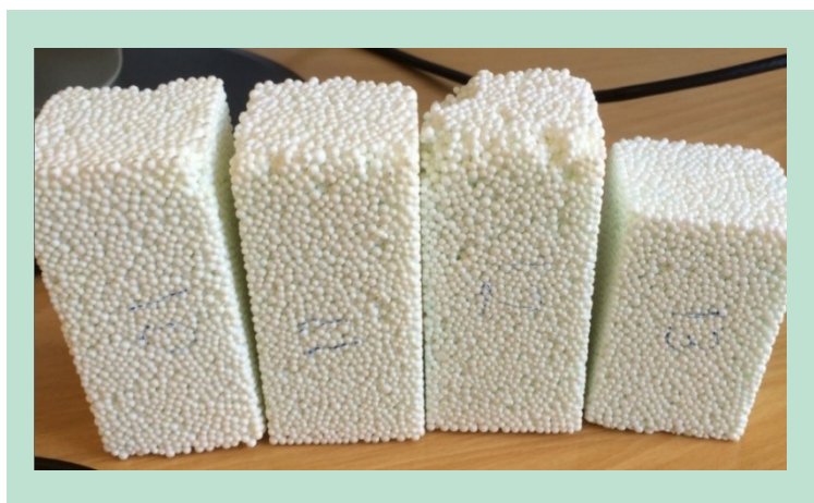
FIGUR 8 Billede af støbte blokke ved brug af modelværktøjet
