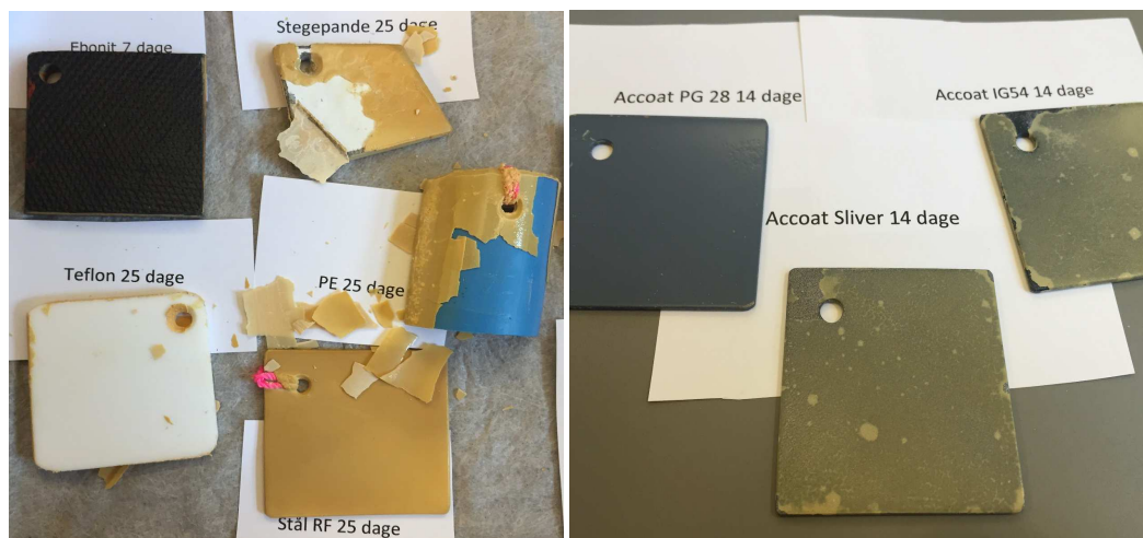
Figur 14 Standardmaterialer og coated rustfast stål efter mild håndtering
