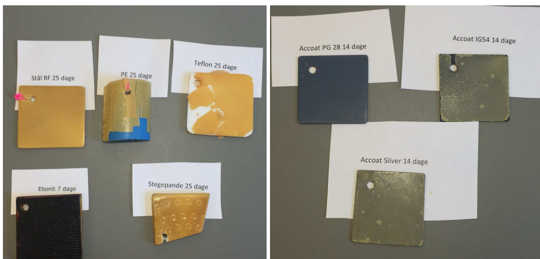
Figur 13 Hyldematerialer og coated rustfast stål med kalkbelægninger
