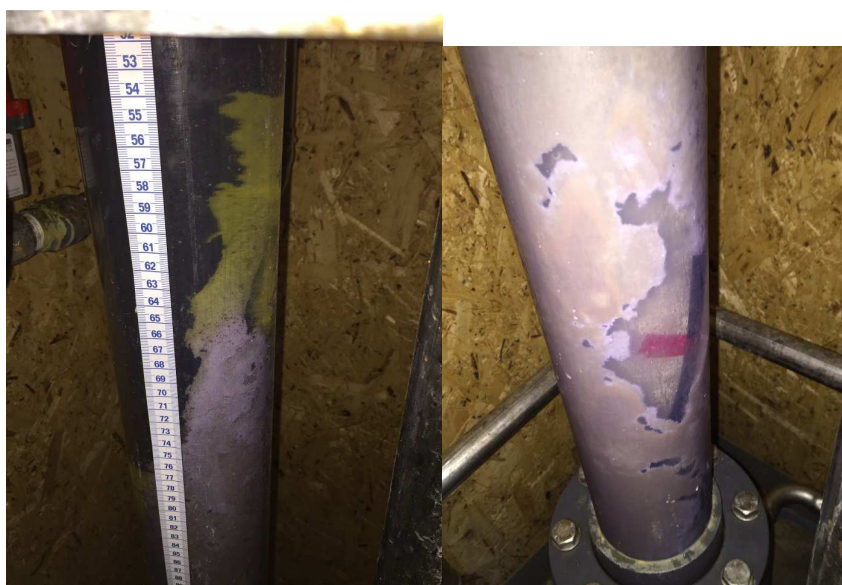
Figur 11. Resultater fra rensning med citronsyre på Dalum Vandværk
