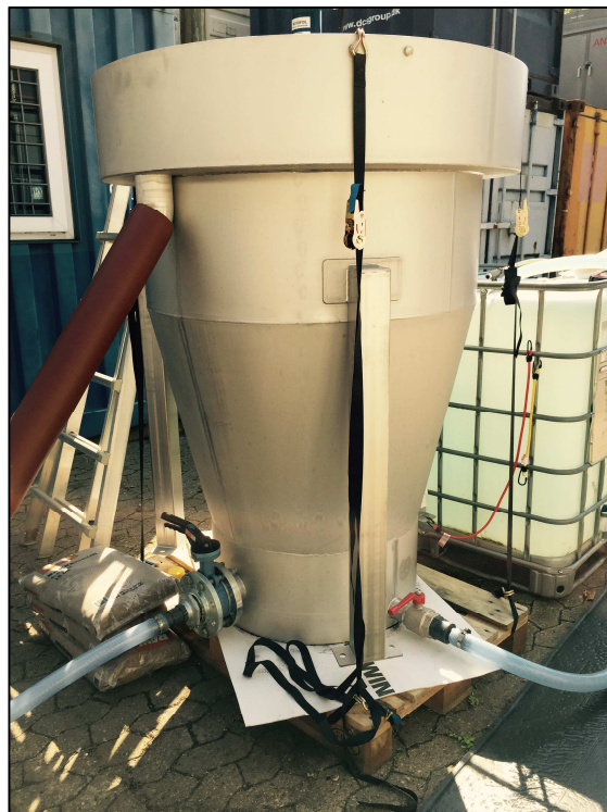
Figur 5.5 Foto af prototype af sandvasker
