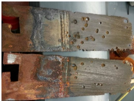
Figur 5 har været udsat for selektiv korrosion, hvilket kun kan skyldes at disse anoder ikke består af rent jern.
