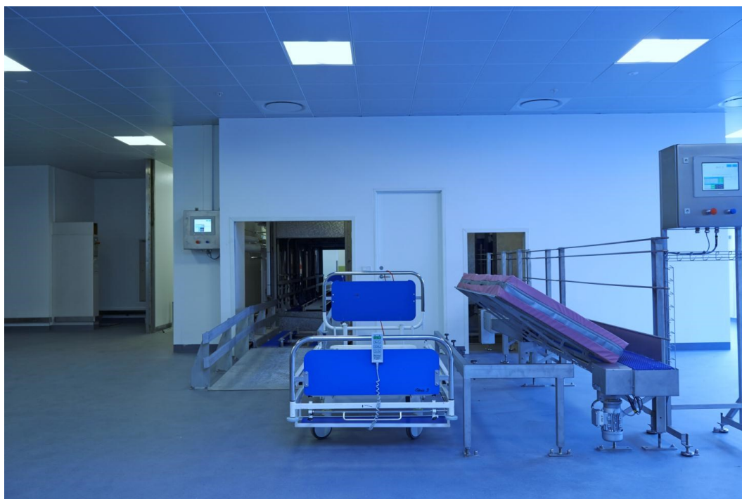
FIGUR 5.2 INTEGRERET SENGE- OG MADRASDESINFEKTIONSSYSTEM FRA SEMI-STAAAL A/S PÅ HVIDOVRE HOSPITAL (SEMI-STAAAL, 2014).
