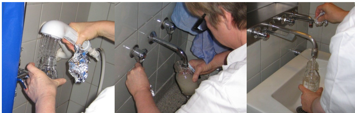
FIGUR 3-8 PRØVETAGNING PÅ AFSNIT 2124. TIL VENSTRE SES PRØVETAGNING FRA EN BRUSER MED FILTERENHED, IMIDTEN SES PRØVETAGNING FRA EN RENGØRINGSHANE I AFFALDSRUMMET OG TIL HØJRE SES PRØVETAGNING FRA EN VASK I PERSONALERUMMET.
