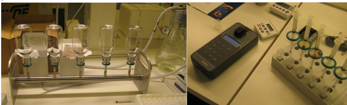
FIGUR B1- 1 ANALYSER MED BACTIQUANT METODEN. TIL VENSTRE SES PRØVER, DER LIGE ER BLEVET FILTRERET. TIL HØJRE SES FLUORESCENSMÅLEREN OG PRØVERNE.
