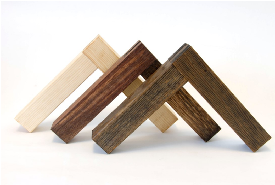
BILLEDE 7: ILLUSTRATION AF TRÆKONSTRUKTION I HENHOLDSVIS UBEHANDLET TRÆ (BAGERST), TEAK (MIDTEN) OG DWT IMPRÆGNERET TRÆ MED TRÆTJÆRE (FORREST)
