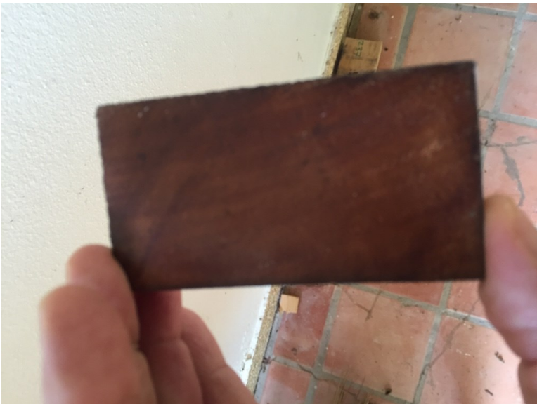
BILLEDE 4: DWT IMPRÆGNERET TRÆ MED TRÆTJÆRE. INGEN SPOR AF TERMITTER
