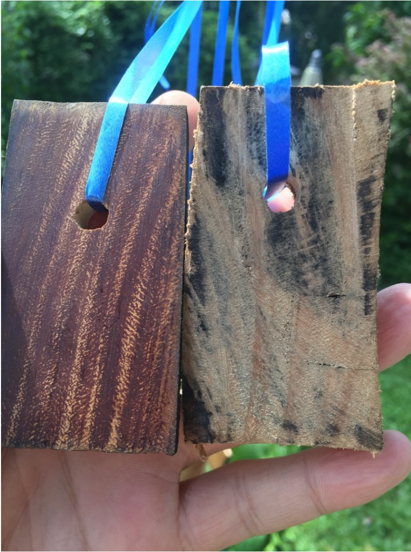
BILLEDE 2: EUCALYPTUS RÅD OG FORM PÅVIRKNING EFTER 6 MÅNEDER I TROPERNE (THAILAND). TRÆ BEHANDLET MED TRÆTJÆRE (TV) OG UBEHANDLET TRÆ (TH).
