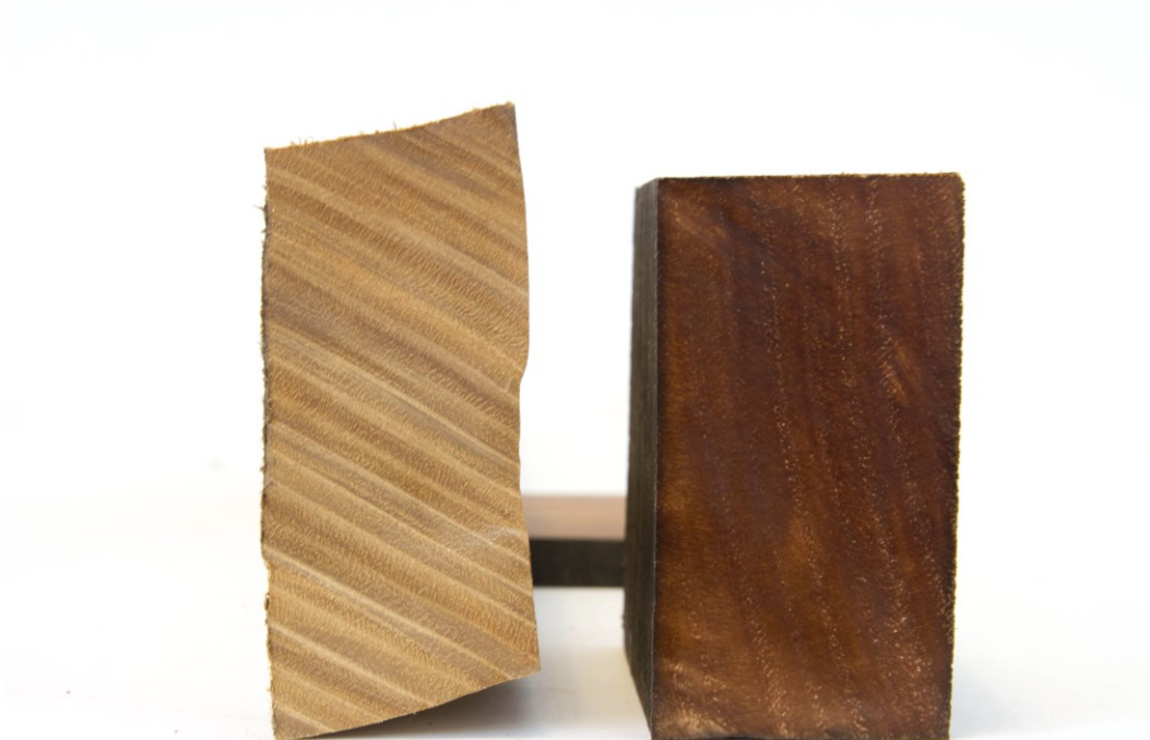
BILLEDE 5: FORMSTABILITET VED BEHANDLET OG UBEHANDLET EUKALYPTUS.
