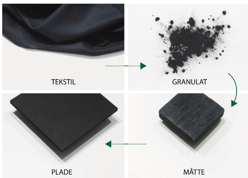
Illustration 1: De fire faser, fra tekstil til plademateriale.
