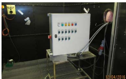
Figur 15. Opstilling for temperatur og fugtighedstest.
