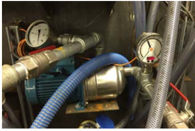
Figur 8. Test og optimering af permeat-pumpe
