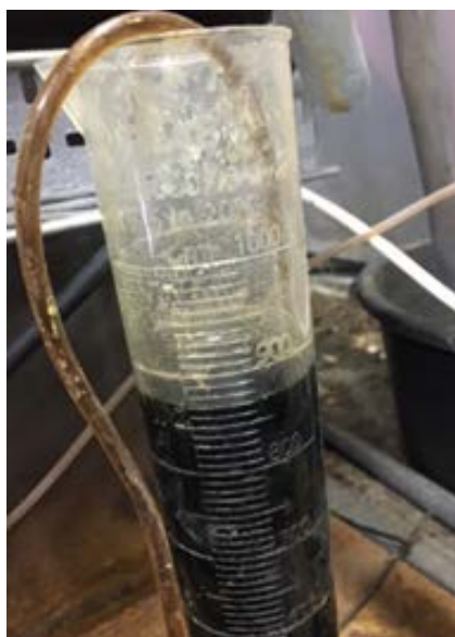
Figur 11. Test af forsfjernelse-effektivitet (PIX-113)
