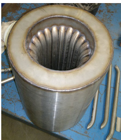
FIGUR 3 VARMEVEKSLER MED RØR TIL KORROSIONSTEST
