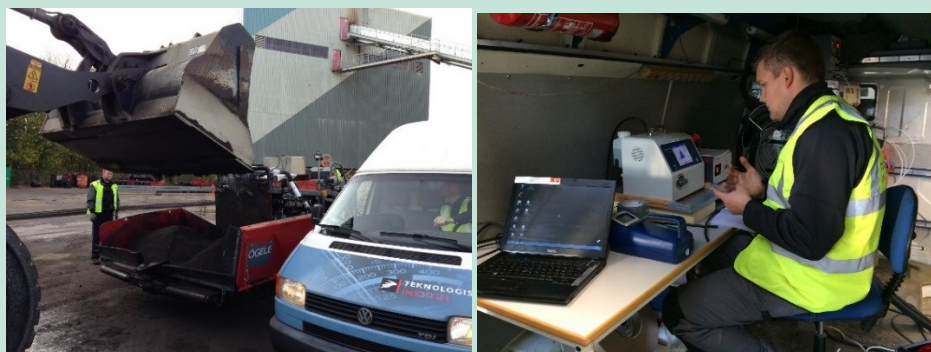
FIGUR 5 BILLEDER FRA EMISSIONSMÅLING PÅ ASFALTUDLÆGGER PÅ TESTSTRÆKNING VED NCC ROADS A/S – SAMME MASKINE (ASFALTUDLÆGGER), SOM SKAL RETROFITTES I PROJEKTET.
