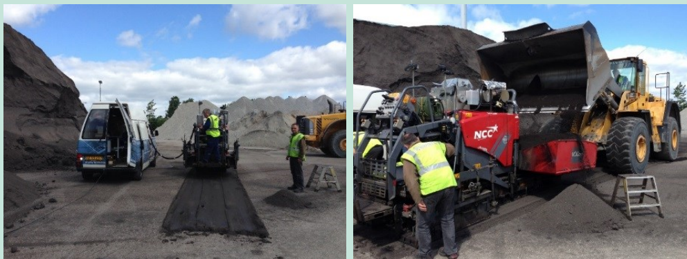
FIGUR 10 BILLEDER FRA EMISSIONSMÅLING PÅ ASFALTUDLÆGGER MED PÅMONTERET KOMBINATIONSLØSNING VED NCC ROADS I EJBY.
