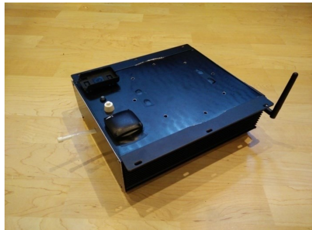
BILLEDE 2 DETECTOR 1XB SENSORBOKS TIL DRONE OG INDBYGGET TIL MONTERING PÅ HELIKOPTER
