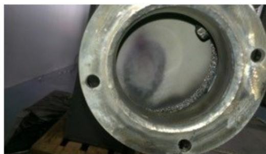
BILLEDE 3 BESKADIGET KATALYSATORSUBSTRAT EFTER TEST 1
