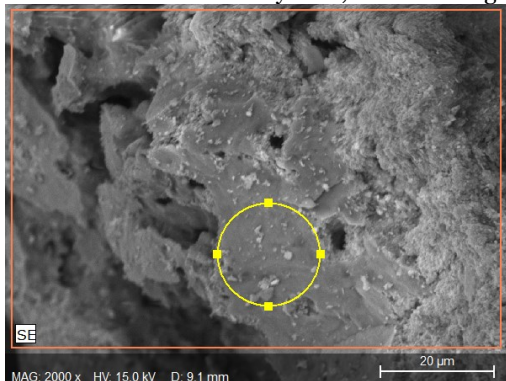
Figur 3: SEM-billede af det materiale, der er påført katalysatorbærematerialet. Den gule cirkel viser, hvor der er foretaget EDS-elementanalyse.
