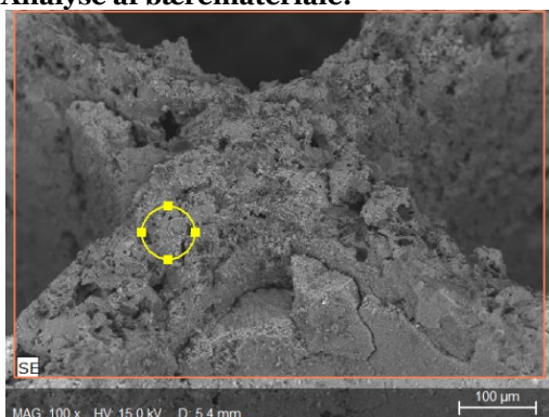
Figur 2: SEM-billede af katalysatorbærematerialet. Den gule cirkel viser, hvor der er foretaget EDS-elementanalyse.
