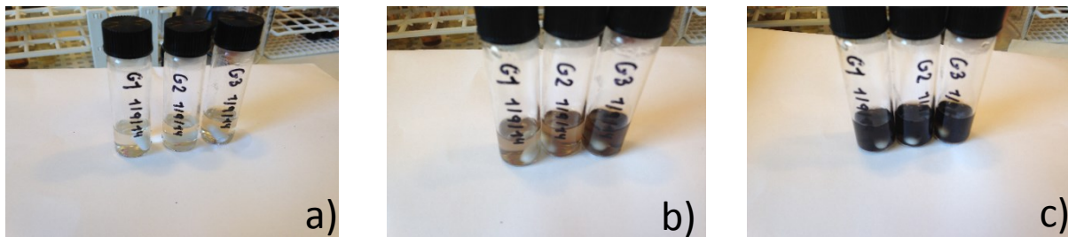
FIGUR 6 TEMPERATURFORSØG MED KATALYSATOR K_3 OG FARVESTOF F6 VED TRE FORSKELLIGE TEMPERATURER EFTER HENHOLDSVIS A) 0 MINUTTER, B) 30 MINUTTER OG C) 60 MINUTTER.
