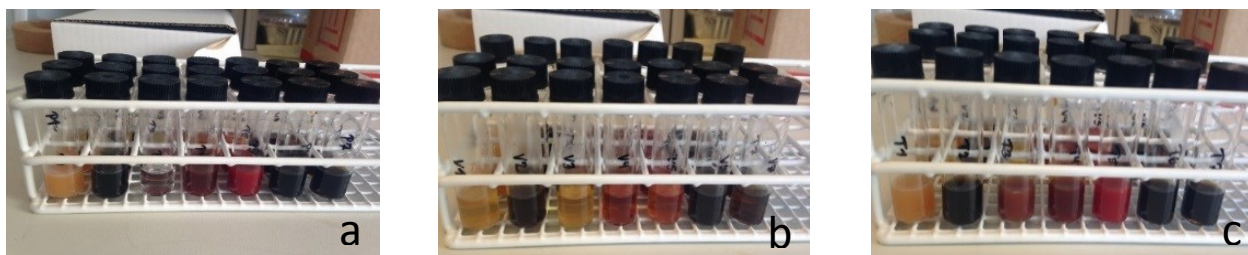
FIGUR 4 FORSØGSRÆKKER MED FORØGELSE AF FARVESTOFMÆNGDE FOR AT OPNÅ ØGET FARVESTYRKE. REAKTIONERNE ER FOTOGRAFERET EFTER 3,5 TIME FOR DE TRE KATALYSATORER. A) K 1 , B) K 2 OG C) K 3
