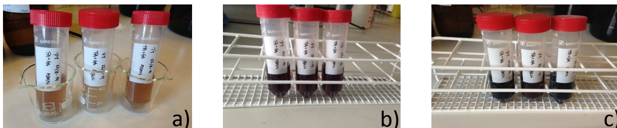
FIGUR 5. FORSØG MED REAKTIONSTID. PRØVERNE ER FOTOGRAFERET I TIDSINTERVALLERNE A) LIGE TILFØRT KATALYSATOR, B) EFTER 1 TIME OG C) WEEKENDEN OVER.
