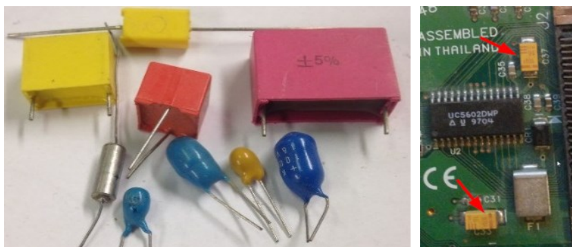
FIGUR 3 BILLEDE AF HENHOLDSVIS TANTALKONDENSATORER MED OG UDEN BEN
