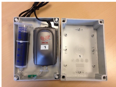
FIGUR 5: PUMPEENHED MED LUFTPUMPE (I HØJRE SIDE) OG KULFILTER (I VENSTRE SIDE) BENYTTET TIL PILOTPROJEKT.
