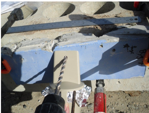
FIGUR 16: MODIFICERET MUNDSTYKKE TIL OPSAMLING AF BOREMEL. HER OPSAMLES BOREMEL PÅ ALUFOLIE MONTERET I MUNDSTYKKET (UDEN STØVSUGER).
