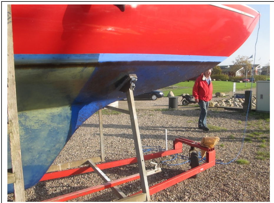
Figur 8.2. Horsens sejlbåd efter 4 måneder i vandet. Til højre ses testmalingen fra 2014 og til venstre ses referencemalingen. Der er ingen væsentlig forskel mellem de to malede overflader. Der er et slimlag på begge malinger.
