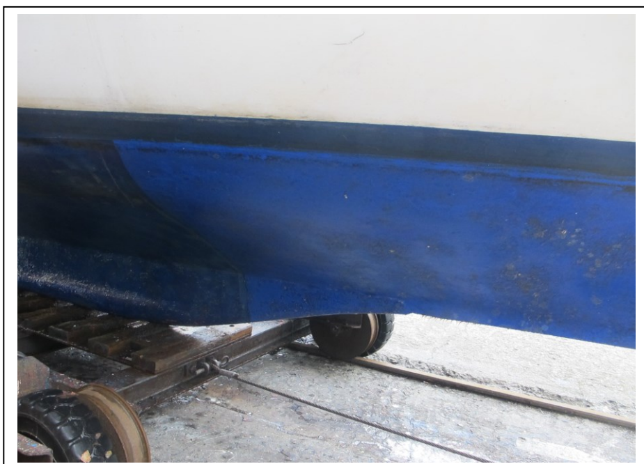
Figur 8.4. Svanemøllens motorsejler efter 4 måneder i vandet. Til højre ses testmalingen fra 2014 og til venstre ses referencemalingen. Billedet er repræsentativt for begge de malede arealer. De er ingen forskel i resultat mellem de to malede flader.
