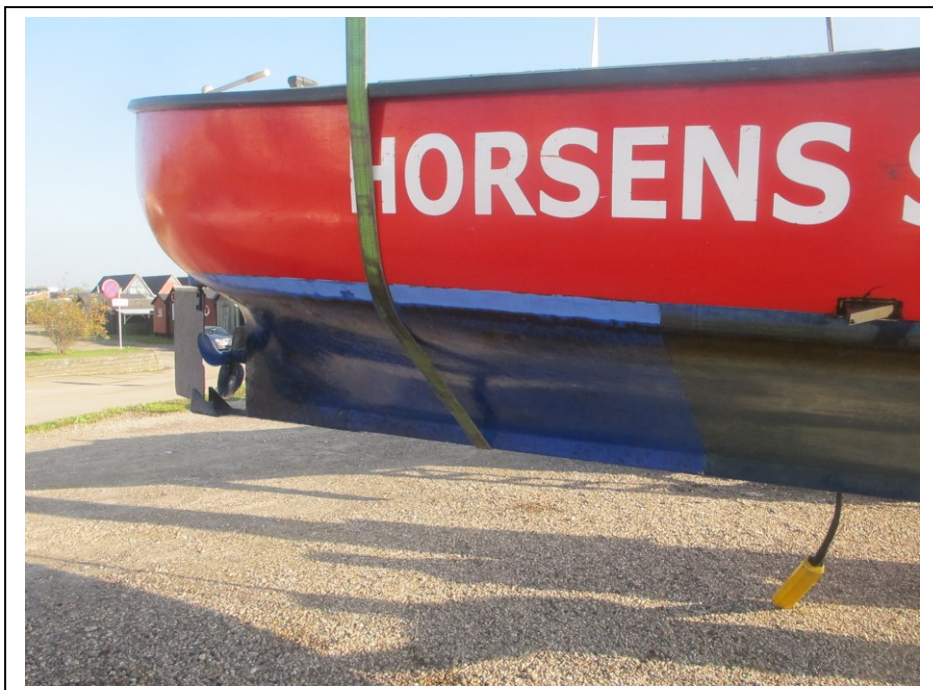
Figur 8.1. Horsens motorjolle efter 5 måneder i vandet. Til venstre ses testmalingen fra 2014 og til højre ses referencemalingen. Der er ingen væsentlig forskel mellem de to malede overflader. Der er et slimlag på begge malinger.
