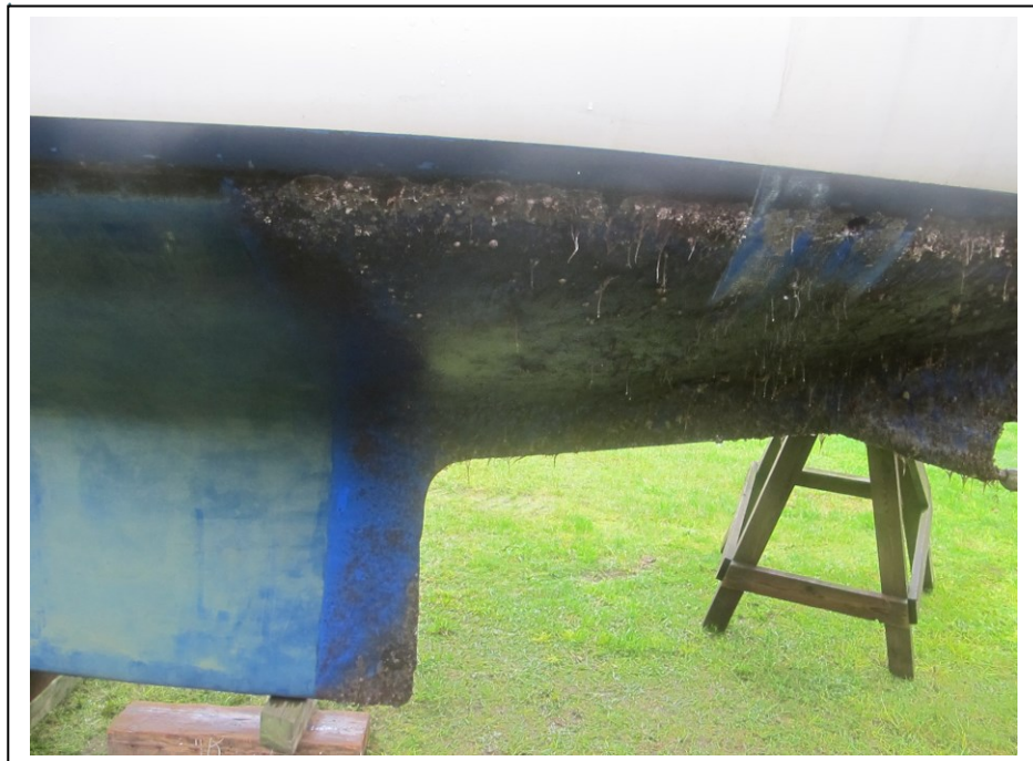
Figur 8.7. Jyllinge motorsejler efter knap 4 måneder i vandet. Til højre ses testmalingen fra 2014 og til venstre ses referencemalingen. Det er mere begroning på testmalingen end på referencemalingen.
