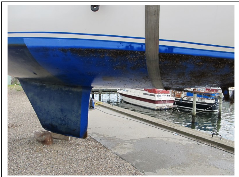
Figur 8.3. Horsens sejlbåd efter 3 måneder i vandet. Til højre ses testmalingen fra 2014 og til venstre ses referencemalingen. Begroningen var mest udtalt på agterpartiet med testmalingen.
