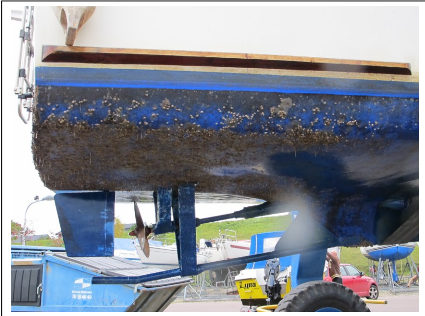
Figur 8.5. Jyllinge motorbåd efter 6 måneder i vandet. Til venstre ses testmalingen fra 2014 og til højre ses referencemalingen. Begroningen i stævnen er knap så udtalt som i agter og under bagpartiet. Testmalingen gav et væsentlig dårligere resultat end referencemalingen.
