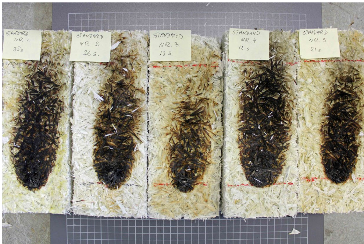
Fig. 9: Billede af ubehandlede prøveemner efter test i.h.t. DIN 4102.
