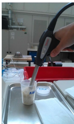
FIGUR 6 EKSEMPEL PÅ HVORDAN DER VED HJÆLP AF EN FIBEROPTISK PROBE OPTAGES ET SPEKTRUM VED BRUG AF NIR-SPEKTROSKOPI. PRØVEBEHOLDEREN BESTÅR AF RÅFJER, SOM ER REPRÆSENTATIVT UDTAGET FRA DE ENKELTE BATCHES.
