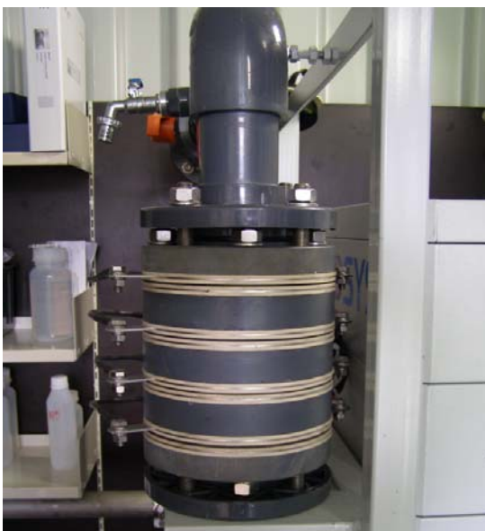
Figur13: Katoder og anode for kemisk desinfektion (A) og Testanlæg (B).
