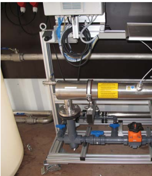
Figur 11: Forsøgsopstilling med UV-anlæg fra Xylem (Wedeco)
