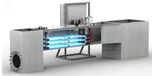
Figur 8: Eksempel på UV-standardanlæg til rensning af spildevand.
