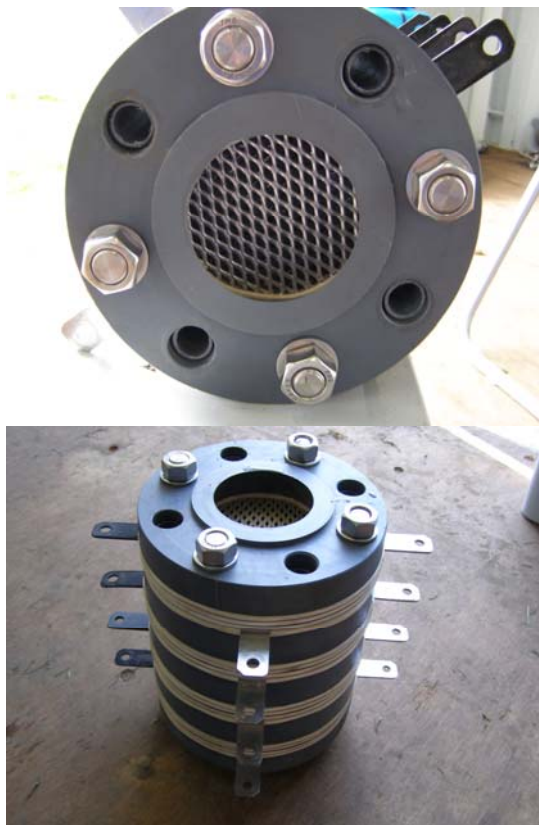
Figur 14: Testanlæg for elektrokemisk desinfektion – Elektrokemiske celler.
