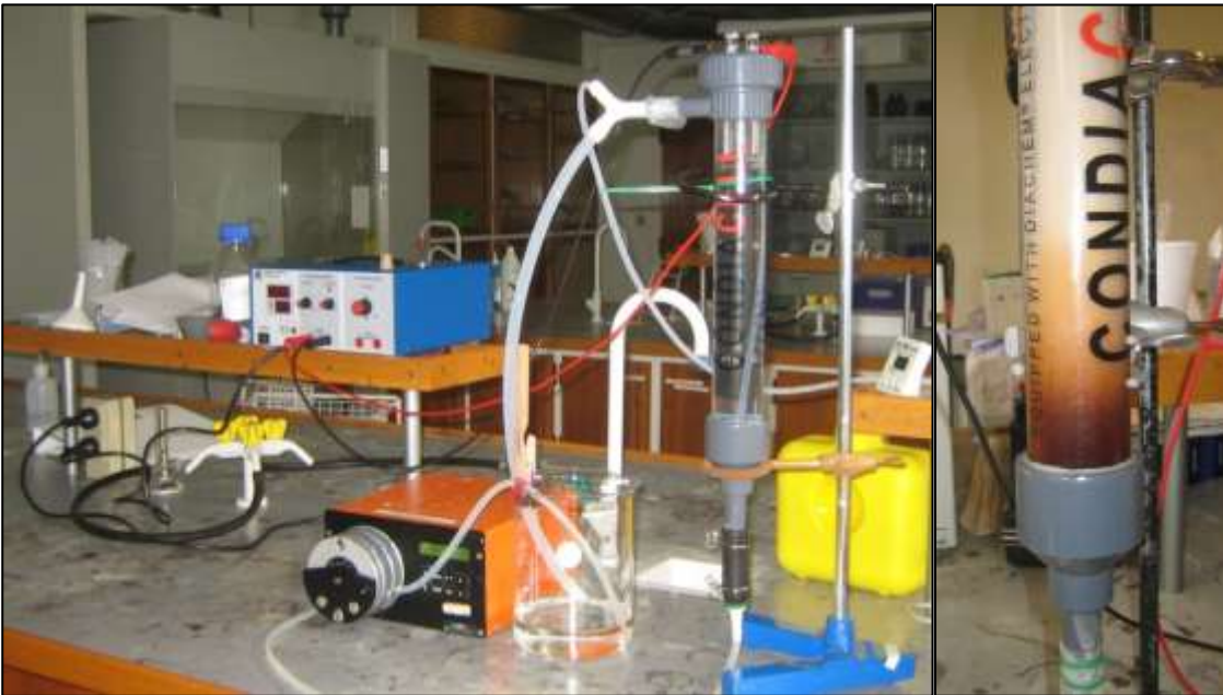
Figur 4 : Opstilling til undersøgelse af effekten af elektrooxidation. Billedet til højre viser hvordan der dannes en stor mængde luft i reaktoren (- primært ilt og brint fra hydrolysen af vand).
