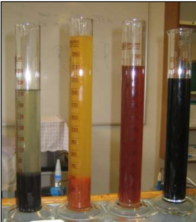
Figur 5: Illustration af effekten af elektrooxidation på en prøve af UF-koncentratet. Helt til højre ses den ubehandlede prøve, som nr. 2 fra højre den oxiderede prøve efter 30 minutters behandling. Nr. 3 fra højre er den oxiderede prøve efter fældning med Kemiras udviklingsprodukt og prøven helt til venstre er koncentrat efter fældning med Kemiras udviklingsprodukt (uden oxidation).
