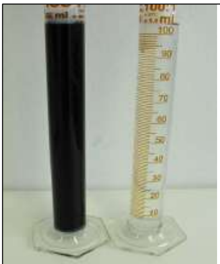
Figur 3: Før og efter behandling med Montalkal 1007 plus og Liqui Crack 31 – combikem's metode.
