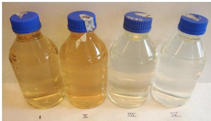
**Figur 12.6** Prøver fra Skagen, fra venstre mod højre: Råvand (I), efter INKA beluftning (II), efter rentvandstank (III) og fra ledningsnettet (IV).
