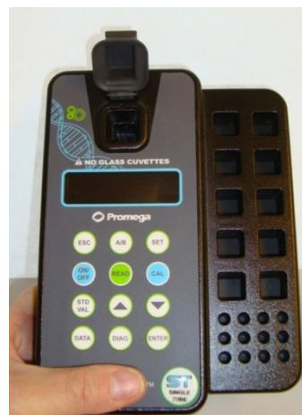
**Figur 9.4. Håndholdt fluorometer til fluorescensmåling.**
