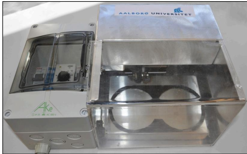
**Figur 10.15.** ColiBox inkubationsboks med varme- og rystefunktion.
