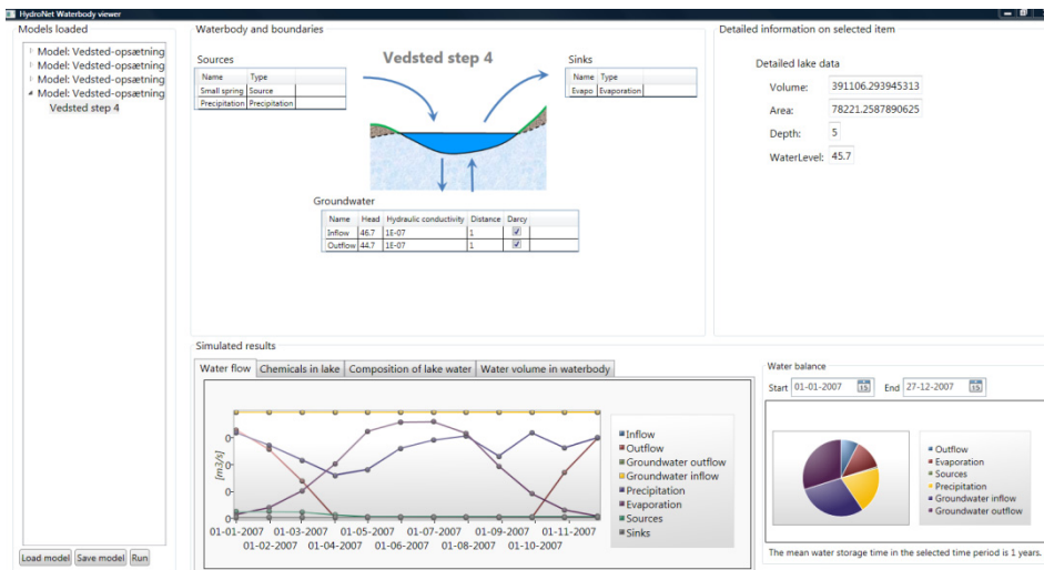
Figur 10 En brugerflade til HydroNet-modellen, som kan vise resultater for et vandelement (Sø eller vandløb).
