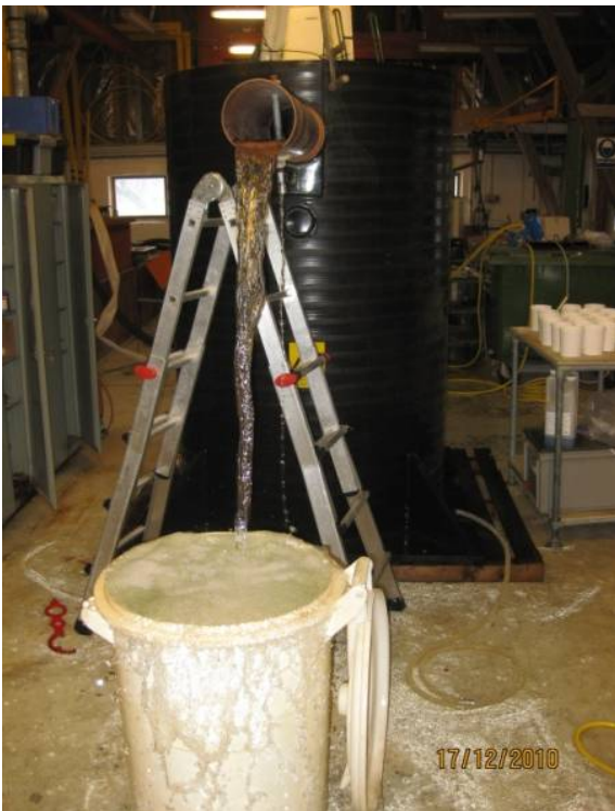
Figur 10 Udløbet fra Watercare 1900 l partikeludskiller under forsøgskørsel.
