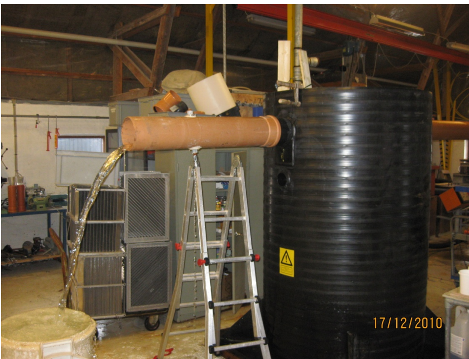
Figur 11 Samme som figur 10. Udløbskoncentrationen af partikler bliver målt ved den studs, der sidder på udløbsrøret ca. 1 meter fra partikeludskilleren.
