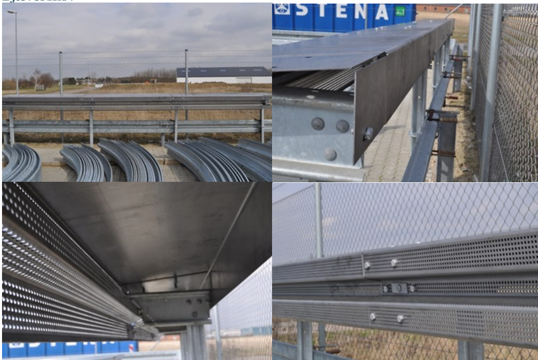
Figur 5. 3 stk. prototyper blev fremstillet og prøvemonteret hos Dansk Autoværn i Bjæverskov
