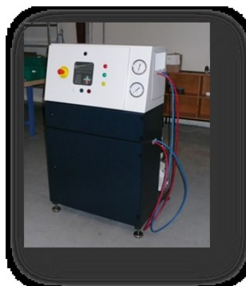
Figur 4 RHS1280 prototype til servicering af MAC med R1234yf kølemiddel
