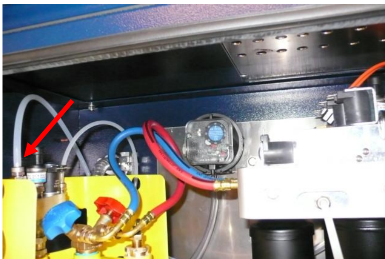
Figur 5 Slange tilslutning til bortledning af ikke kondenserbare gasser
