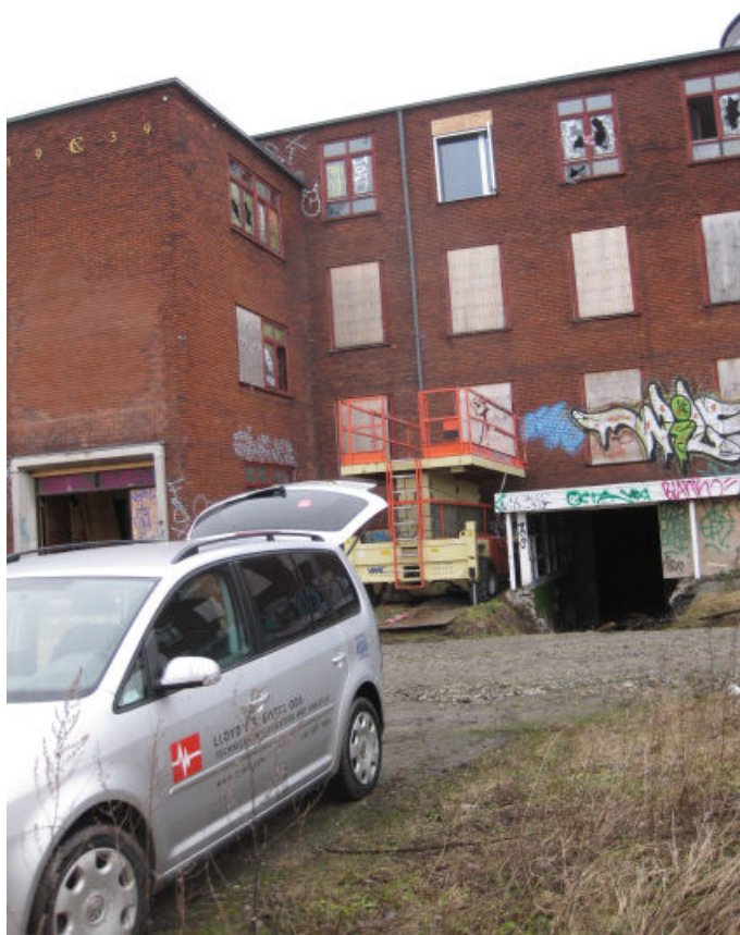
Billede 2 Mock up af vindue monteret på 2. sal set udefra. Højttaler står bag bilen.
