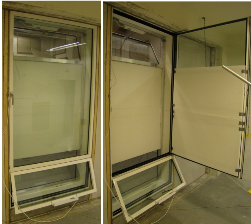
Figur 45: Fotos af den indsatte absorption på vinduets midterparti. Venstre: Absorption kun påsat det udvendige vindueselement. Højre: Absorption påsat begge vindueselementer.
