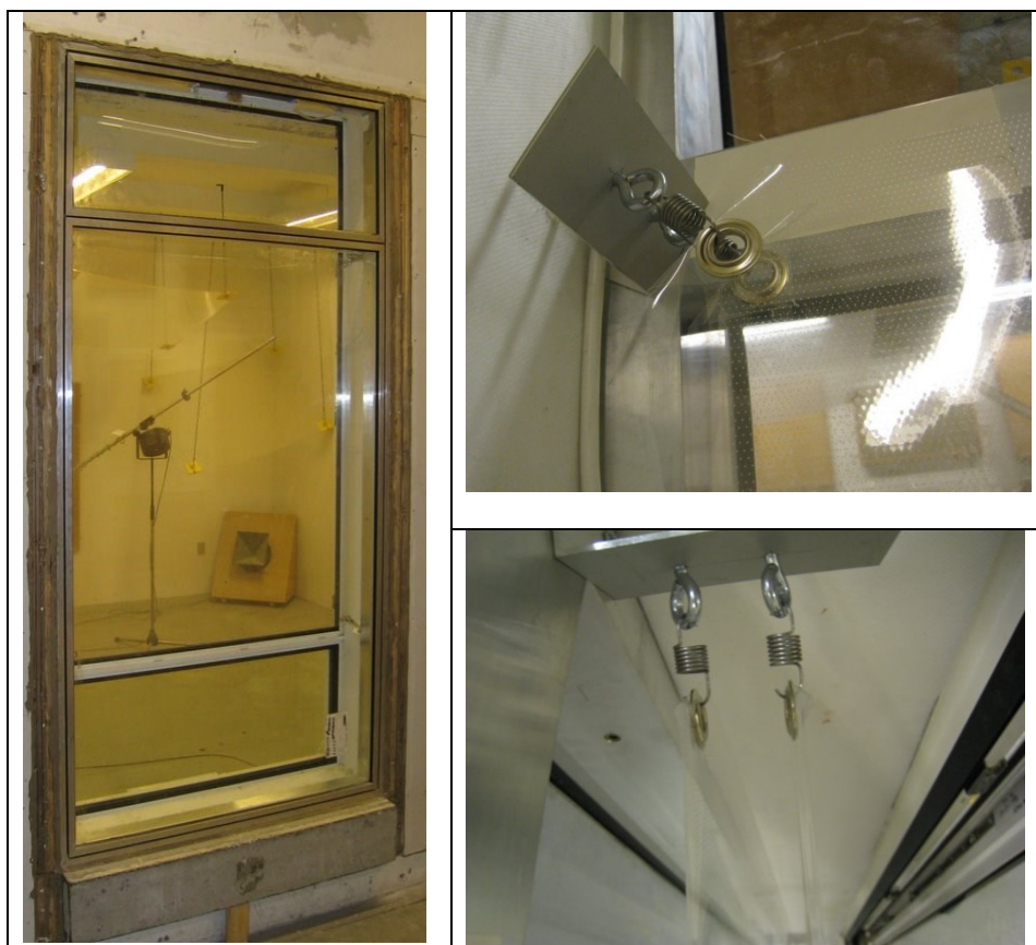
Figur 57: Placering af lydfolie i hulrummet. Selv med to lag folie er gennemsigtigheden ganske god (venstre foto).
