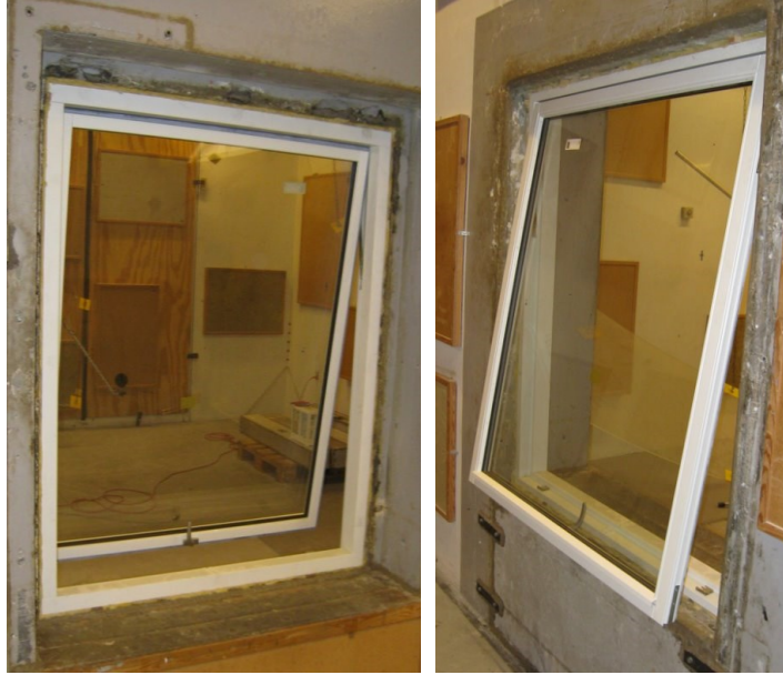
Figur 9: Udvendig trækonstruktion anvendt til undersøgelse af betydningen af oplukkenes højde. Oplukkenes højde er henholdsvis 700 mm, 500 mm og 300 mm.
