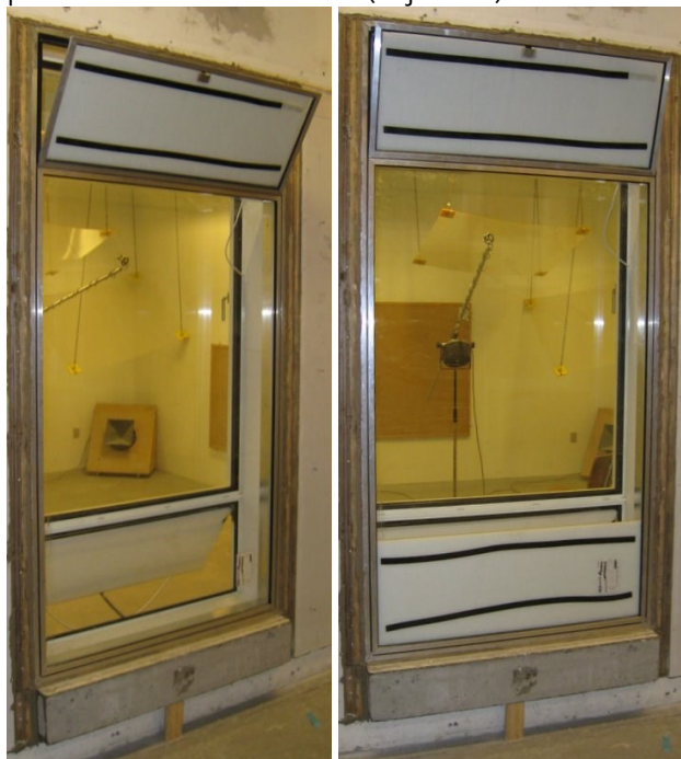
Figur 42: Absorption på den indvendige side af oplukkene (venstre foto) samt yderligere på det modstående rudeareal (højre foto).
