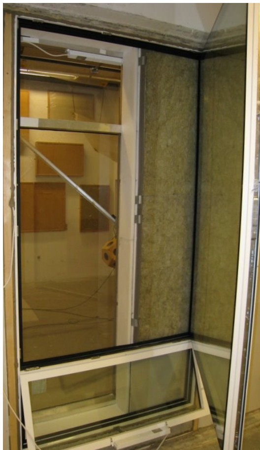
Figur 23: Ændring af vinduesbredden. Den højre del af vinduet er afblændet med en lodret gipsplade. Hulrummet i den afblændede del af vinduet er udfyldt med mineraluld.
