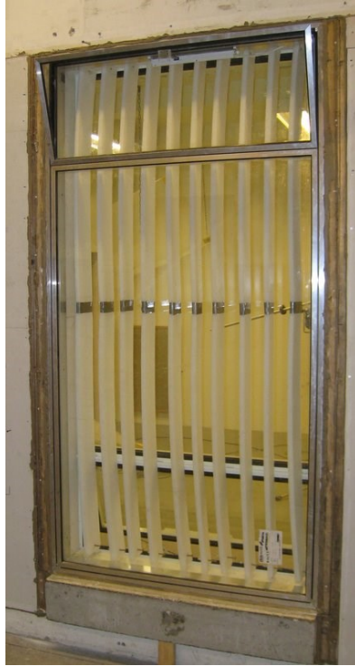
Figur 52: Betydning af lodrette lydabsorberende lameller i hulrummet. Åbningsareal af oplukkene 0,35 \text{ m}^2 | 0,35 \text{ m}^2 .
