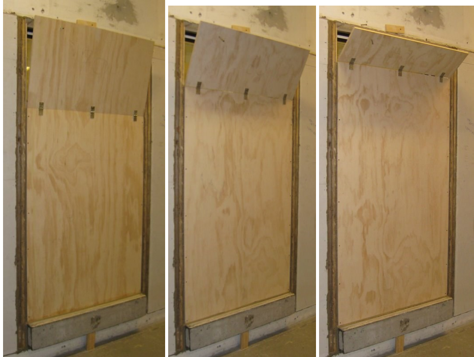
Figur 9: Udvendig trækonstruktion anvendt til undersøgelse af betydningen af oplukkenes højde. Oplukkenes højde er henholdsvis 700 mm, 500 mm og 300 mm.
