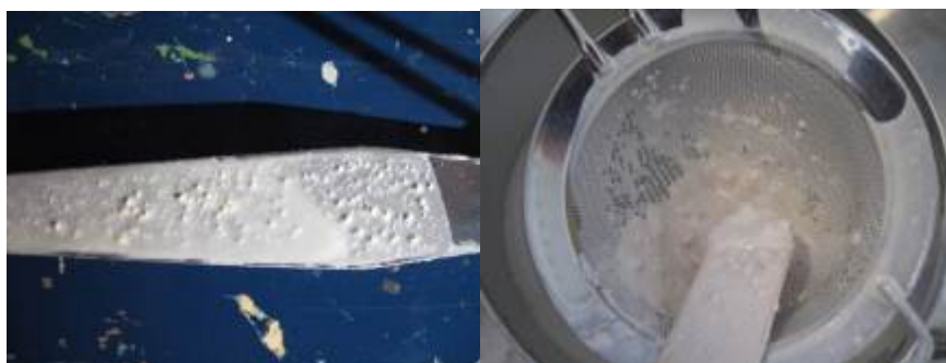
Figur 4.6. Bil leder af ZnPt-partikler i maling under forsøg på oprøring. Til venstre er partiklerne forsøgt udrørt på dissolver uden perler, til højre ses samme prøve under filtrering.
