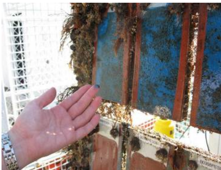
Figur 4.11. Eksempel på selvpolerende maling ved testfacilitet i Spanien. Det ses, at malingen efter ca. 1½ års test kan gnides af med fingeren.
