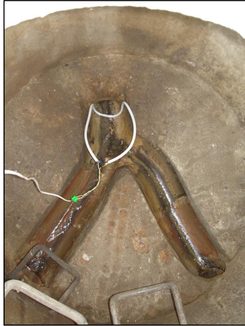
Antenne i samlebrønden, deformeret til at lade tag's passere igennem cirkelantennen
