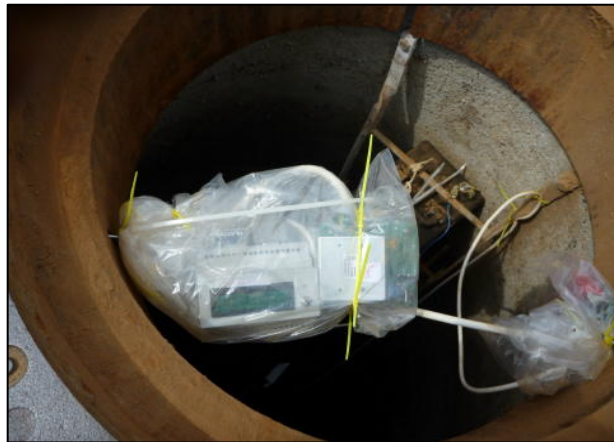
Batteri samt læser, datalogger og antenneforstærker indpakket i plast i spildevandsbrønd
