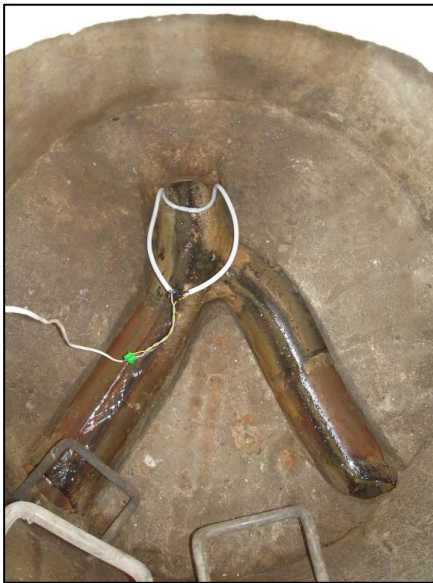
Batteri samt læser, datalogger og antenneforstærker indpakket i plast i spildevandsbrønd
