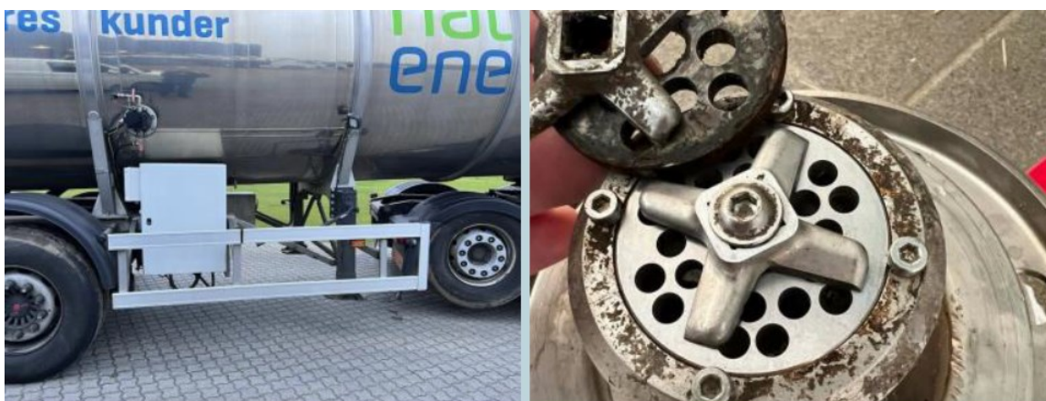
Figur 1: Den mobile Tveskaeg-enhed er installeret på én af Nature Energy's gyllebiler. Th ses neddeleren, der sikrer at prøven kan passere ind i Tveskaeg-enheden
