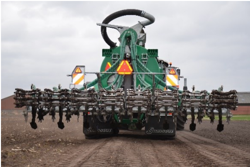
Figur 1. Markdemonstration af den udviklede prototype til placering af gylle til majs i 2021.
